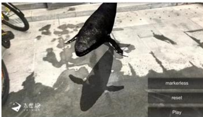
图表90: 通过叠加虚拟坐标系 (海豚) 与真实坐标系 (街道), 实现海豚在虚空中游动的效果
