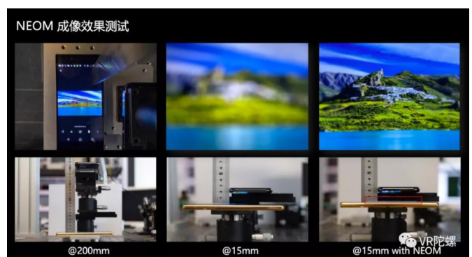
图68: NEO-M 超薄透镜呈像效果测试
