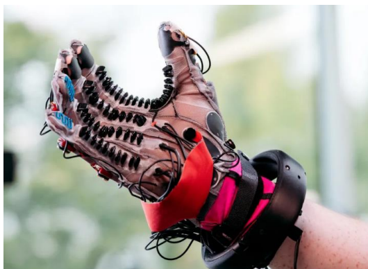
图表73: 触觉反馈手套原型
