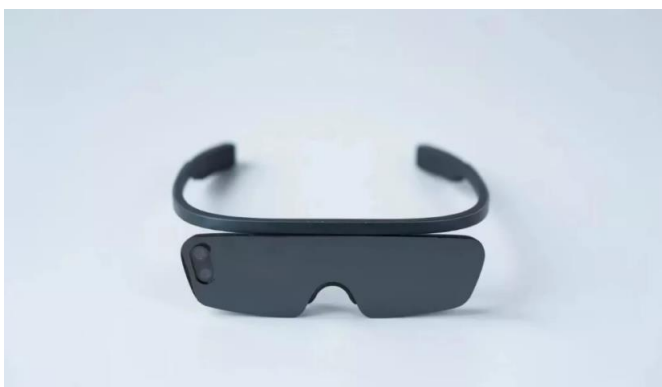
图67: 代号 Ether 的超薄 VR 眼镜原型机
